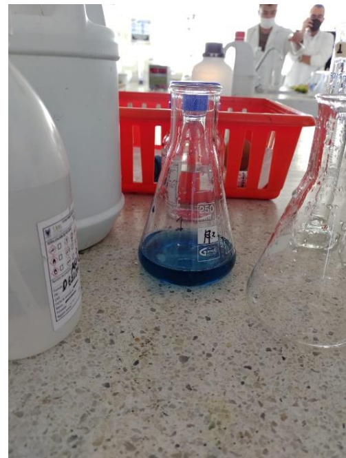
Figura 67. Titulación del parámetro dureza total. Nota. Fuente: Elaboración propia.
