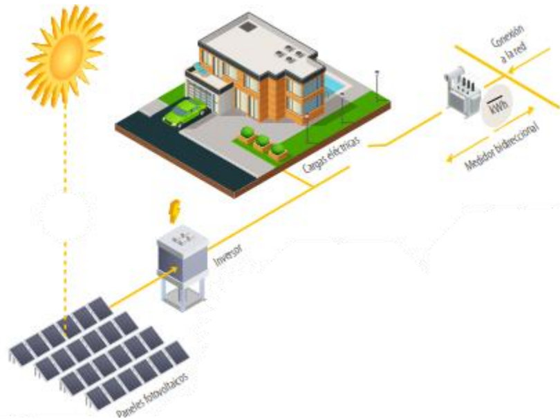
Imagen 7. Sistema de generación fotovoltaico conectado a red.
