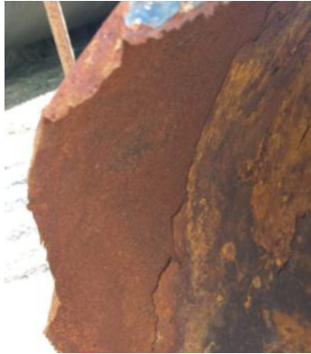
Fig 6. Detalle de capas de óxido
