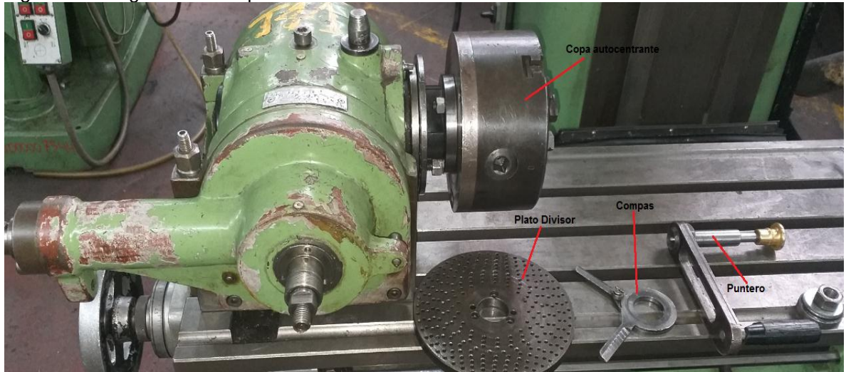
Figura 47. Desgaste en Componentes Divisor Taladro Fresador
