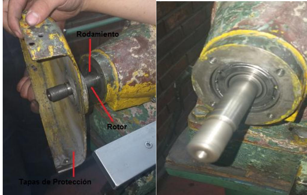
Figura 49. Desgaste Acoples y Tapas de Protección
