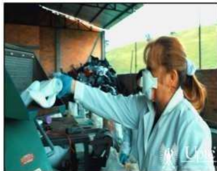
Foto 6. Triturado de residuos sólidos plásticos. (Cartilla Aprovechamiento)
