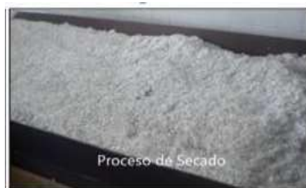
Foto 8. secado de residuos sólidos plásticos triturados. (Cartilla Aprovechamiento)
