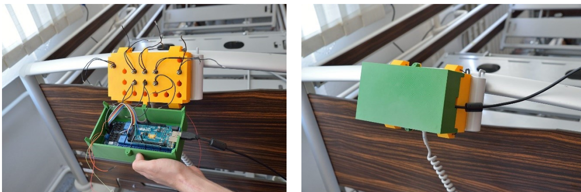
Obr. 15 Na obrázku vlevo je zobrazena ovládací elektronika solenoidů připevněných na ovládací panel Supervisor lůžka Latera. Solenoidy jsou ovládané mikropočítačem Arduino a pod ním uloženou soustavou relé (zelený kryt). Celkový pohled na zkompletovanou experimentální patici včetně napájení je zobrazen na obrázku vpravo.
