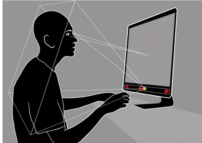
Obr. 3 Ovládací schéma eye-trackingu s externím zařízením se třemi zdroji IR záření a jednou snímací kamerou. Na základě výpočtu POR subjekt interaguje s požadovanou částí displeje.
