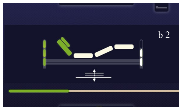
Obr. b 2: Podhlavník v maximální poloze, nelze více polohovat (bílý řádkový středový piktogram). Aktivní prvek zelený, velikost zdvihu aktivní pozice reprezentují zelené krajní oválné piktogramy.
