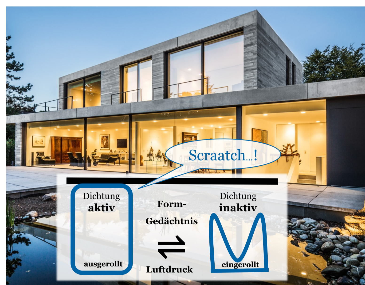
Abbildung 1: Funktionsprinzip von Luftdichtungen bei Air-lux Schiebefenstern.
