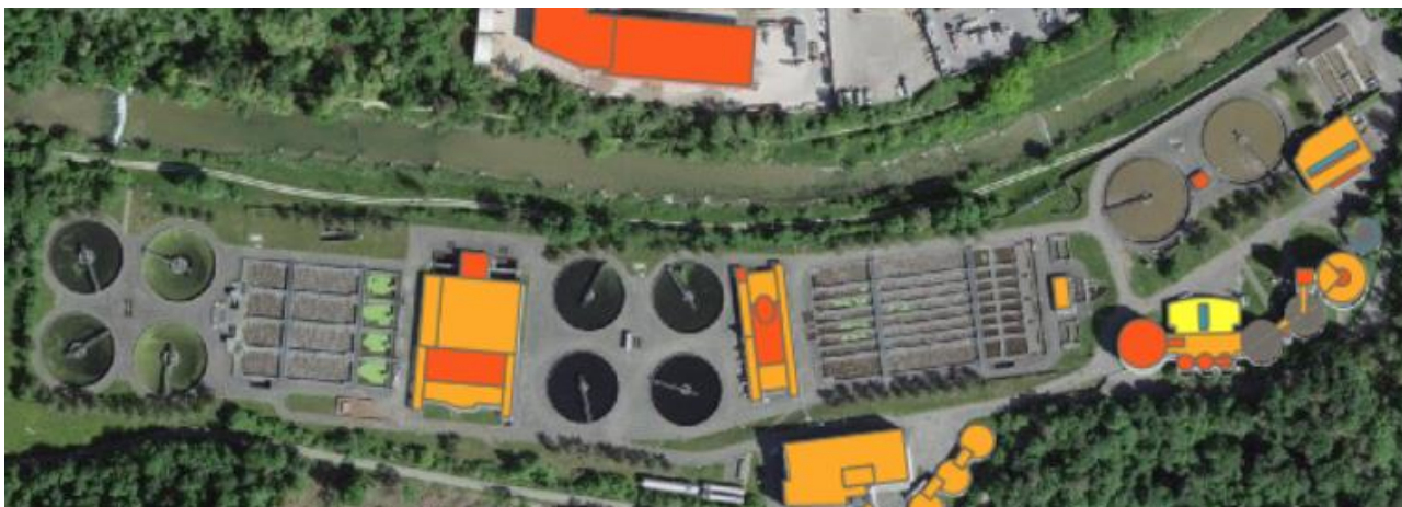
Abbildung 32: Nutzbare Dachflächen gemäss Solardachrechner, Beispiel ARA Hard.
