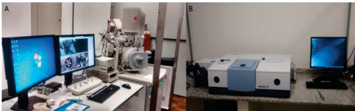
FIGURA 8 – EQUIPAMENTOS UTILIZADOS NAS CARACTERIZAÇÕES. (A) MICROSCÓPIO ELETRÔNICO DE VARREDURA; (B) ESPECTROFOTÔMETRO BRUKER.
