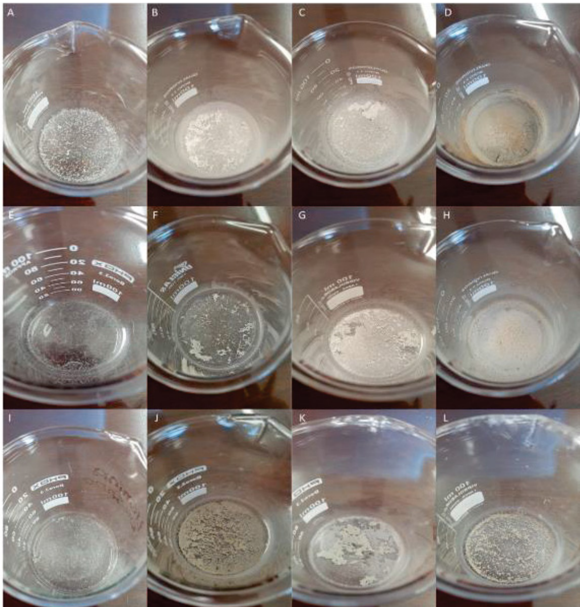
FIGURA 21 – LIGNINAS E NANOPARTÍCULAS DE LIGNINA BRANQUEADAS. LIGNINA KLASON BRANQUEADA (A); NANOPARTÍCULAS DE LIGNINA KLASON BRANQUEADA 2 (B), 8 (C) E 13 PASSES (D); LIGNINA KRAFT BRANQUEADA (E); NANOPARTÍCULAS DE LIGNINA KRAFT BRANQUEADA 2 (F), 8 (G) E 13 PASSES (H); LIGNINA ORGANOSSOLVE BRANQUEADA (I); NANOPARTÍCULAS DE LIGNINA ORGANOSSOLVE BRANQUEADA 2 (J), 8 (K) E 13 PASSES (L).
