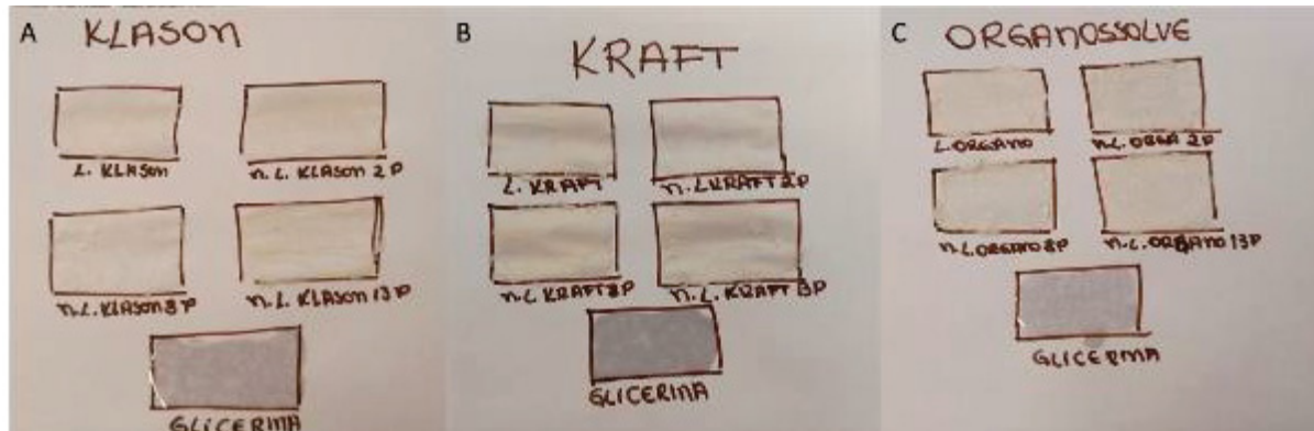
FIGURA 14 – FOLHAS DE PAPEL SULFITE COM AS AMOSTRAS DAS FORMULAÇÕES PARA A ANÁLISE QUALITATIVA. (A) FORMULAÇÕES PREPARADAS COM LIGNINA E NANOPARTÍCULAS DE LIGNINA KLASON BRANQUEADA; (B) FORMULAÇÕES PREPARADAS COM LIGNINA E NANOPARTÍCULAS DE LIGNINA KRAFT BRANQUEADA; (C) FORMULAÇÕES PREPARADAS COM LIGNINA E NANOPARTÍCULAS DE LIGNINA ORGANOSSOLVE BRANQUEADA.
