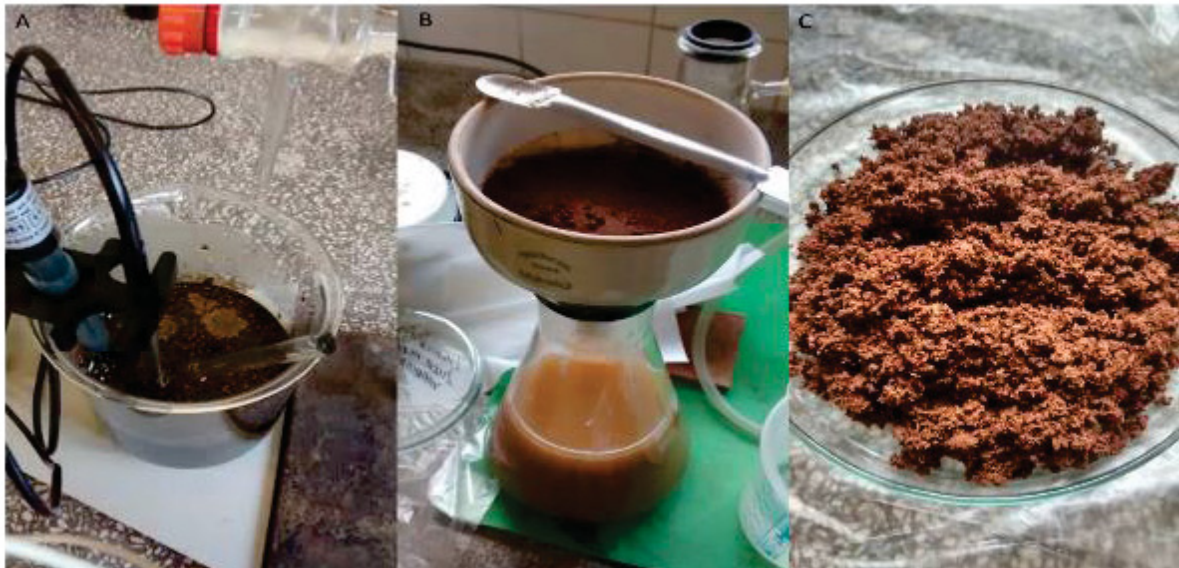
FIGURA 4 – OBTENÇÃO DA LIGNINA ORGANOSSOLVE. (A) ACIDIFICAÇÃO DO LICOR NEGRO; (B) LAVAGEM E FILTRAGEM DA LIGNINA; (C) LIGNINA OBTIDA.
