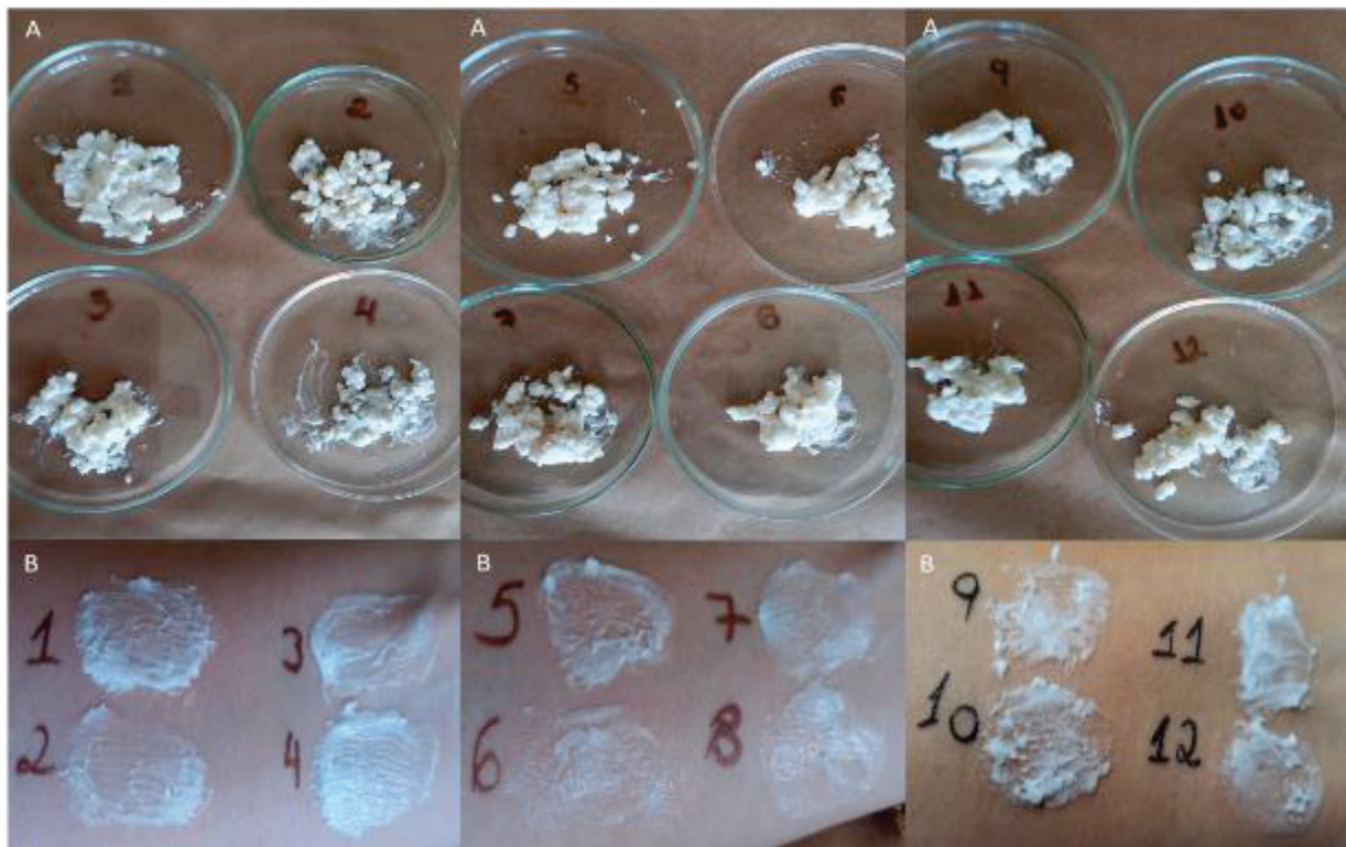
FIGURA 23 – ASPECTO DAS FORMULAÇÕES DESENVOLVIDAS APÓS TESTE DE CENTRIFUGAÇÃO. (A) COM LIGNINA KLASON (1); COM NANOPARTÍCULAS DE LIGNINA KLASON 2 PASSES (2), 8 PASSES (3), 13 PASSES (4); COM LIGNINA KRAFT (5); COM NANOPARTÍCULAS DE LIGNINA KRAFT 2 PASSES (6), 8 PASSES (7), 13 PASSES (8); COM LIGNINA ORGANOSSOLVE (9); COM NANOPARTÍCULAS DE LIGNINA ORGANOSSOLVE 2 PASSES (10), 8 PASSES (11), 13 PASSES (12); (B) IMAGEM DAS FORMULAÇÕES APLICADAS NA PELE: COM LIGNINA E NANOPARTÍCULAS DE LIGNINA KLASON (1, 2, 3 E 4); COM LIGNINA E NANOPARTÍCULAS DE LIGNINA KRAFT (5, 6, 7 E 8) E COM LIGNINA E NANOPARTÍCULAS DE LIGNINA ORGANOSSOLVE BRANQUEADAS (9, 10, 11 E 12).
