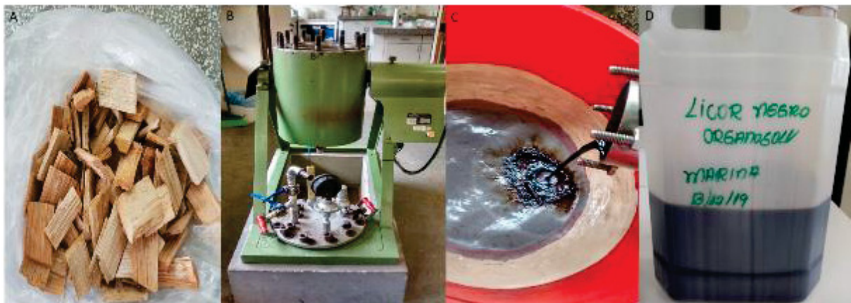
FIGURA 3 – OBTENÇÃO DO LICOR NEGRO ORGANOSSOLVE. (A) CAVACOS SELECIONADOS; (B) DIGESTOR; (C) RECOLHIMENTO DO LICOR NEGRO; (D) LICOR NEGRO OBTIDO.
