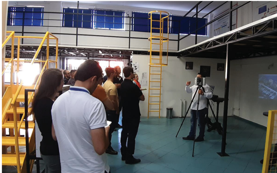
FIGURA 7 - EQUIPAMENTO LASER SCANNER DURANTE CAPTURA.
