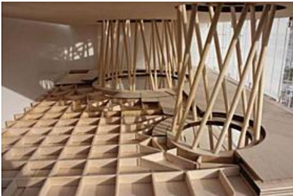
FIGURA 23 - MAQUETE MOSTRANDO A ESTRUTURA DA RETÍCULA DE VIGAS METÁLICAS E OS TUBOS
