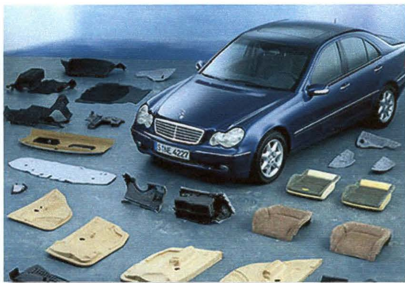
Figura 1 – Componentes de automóvel feitos de fibras vegetais.
