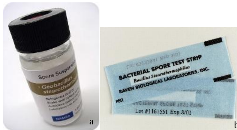
FIGURA 3 –FORMAS DE APRESENTAÇÃO COMERCIAL DE ESPOROS DE G. stearothermophilus . A) SUSPENSÃO DE ESPOROS B) EM SUPORTE DE PAPEL. FONTE: A-NAMSA BIOLOGICAL INDICATORS, 2008. B- MESALABS, 2010
