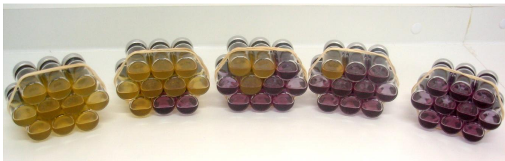
FIGURA 19 – EXEMPLO DE RESULTADO DO TESTE DE RESISTÊNCIA TÉRMICA PELO MÉTODO DA FRAÇÃO NEGATIVA. FONTE: O AUTOR.
