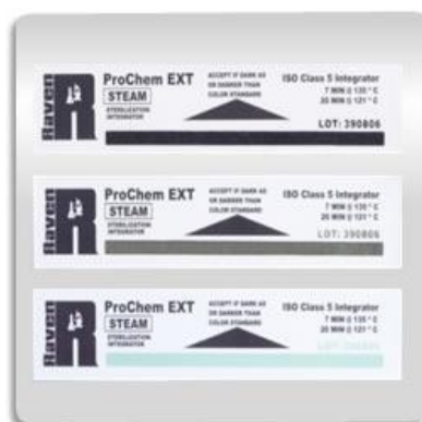
FIGURA 2 – INTEGRADOR QUÍMICO CLASSE 5 INDICANDO, DE CIMA PARA BAIXO, PROCESSO BEM SUCEDIDO, PROCESSO APRESENTANDO FALHA, E INDICADOR NÃO EXPOSTO. FONTE: WWW.SUMMERLIFE.COM
