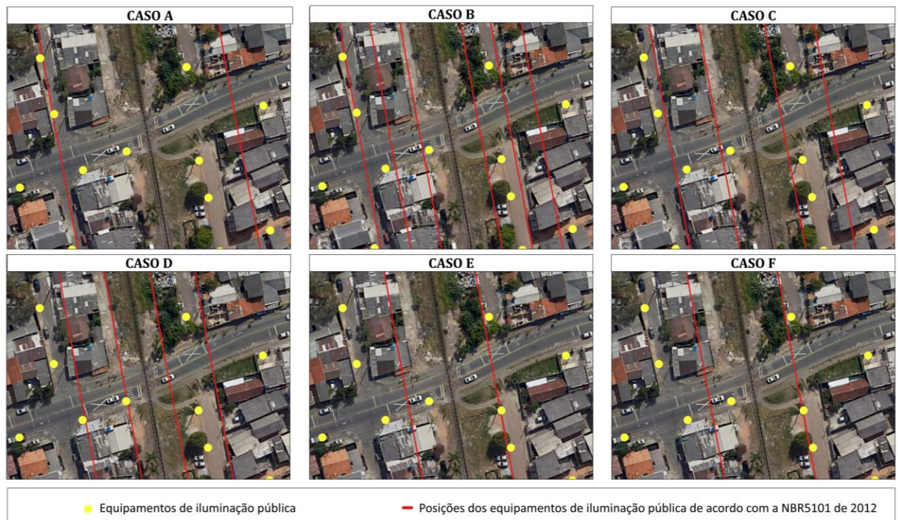
FIGURA 29. REPRESENTAÇÃO DA POSIÇÃO DOS POSTES DE ILUMINAÇÃO PÚBLICA, SEGUNDO A NBR5101 (2012), PARA A PN02,
