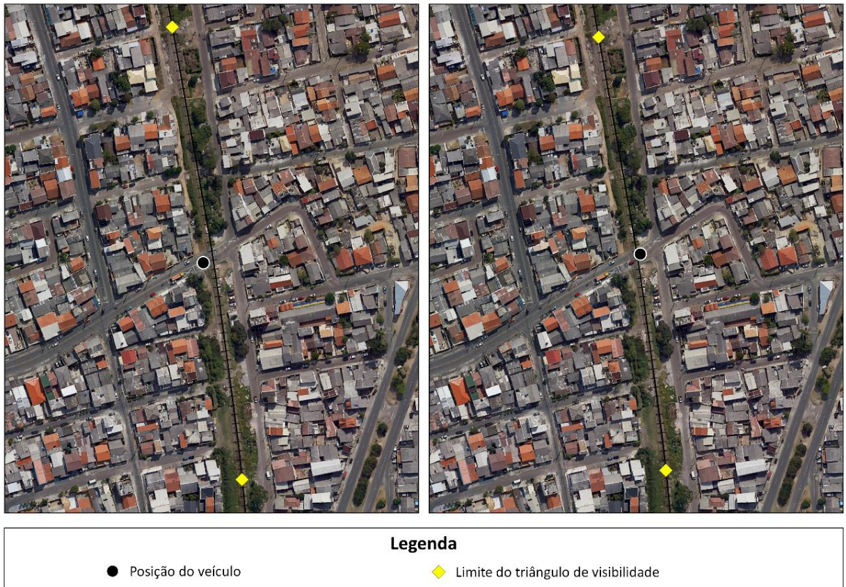
FIGURA 24. REPRESENTAÇÃO DA POSIÇÃO DOS VÉRTICES DOS TRIÂNGULOS DE VISIBILIDADE DA PN03.
