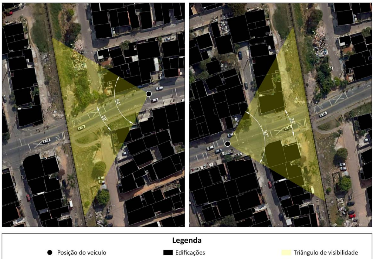
FIGURA 23. REPRESENTAÇÃO DO TRIÂNGULO DE VISIBILIDADE NA PN02.
