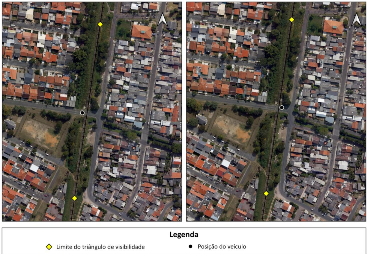
FIGURA 26. REPRESENTAÇÃO DA POSIÇÃO DOS VÉRTICES DOS TRIÂNGULOS DE VISIBILIDADE DA PN04.
