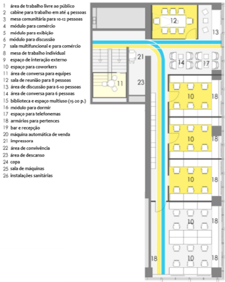
FIGURA 40 – PLANTA DO SEGUNDO ANDAR.
