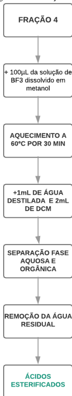
Figura 10: Diagrama esterificação dos ácidos graxos
