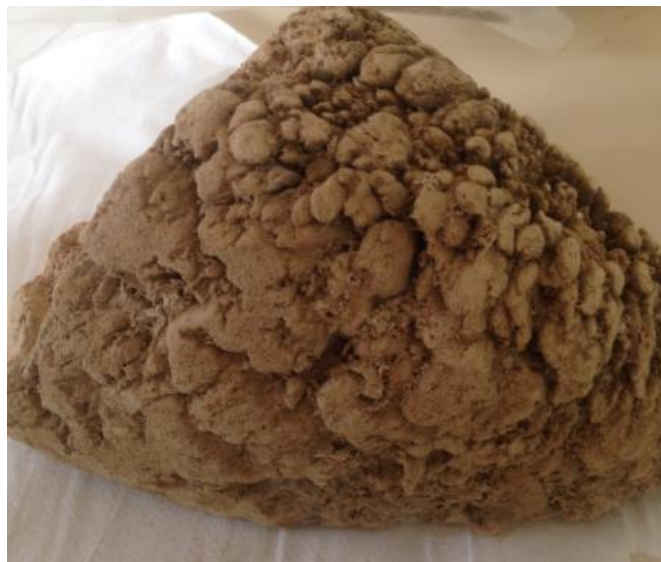
Figura 1: Tufa Calcária – Amostra retirada da área de estudo
