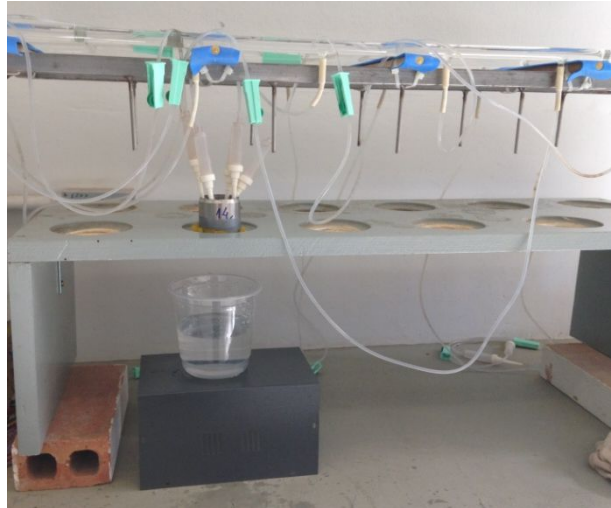
FIGURA 10 - PERMEÂMETRO DE CARGA CONSTANTE DO LHI-NEAB UTILIZADO PARA A ANÁLISE DA PERMEABILIDADE DO SUBSTRATO SATURADO
