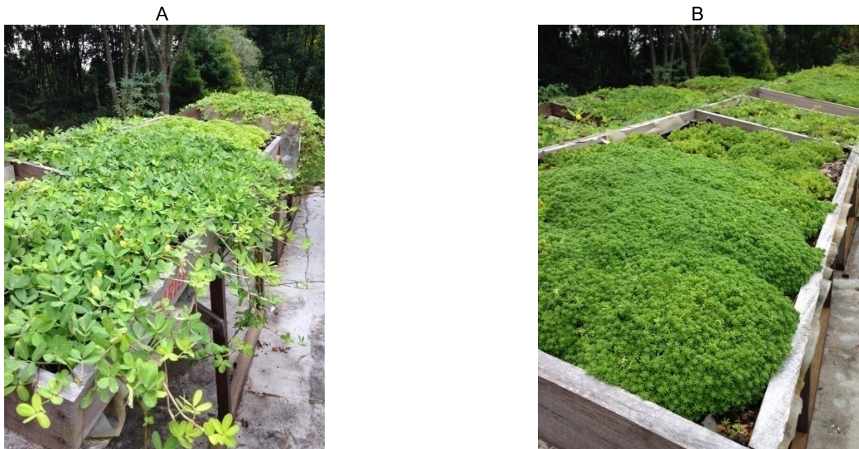
FIGURA 6 - IMAGEM OBTIDA EM MARÇO DE 2015 DOS TELHADOS VERDES EXPERIMENTAIS INSTALADOS NA FAZENDA CANGUIRI DO SETOR DE CIÊNCIAS AGRÁRIAS DA UFPR. A) GRAMA AMENDOIM. B) SEDUM ACRE.
