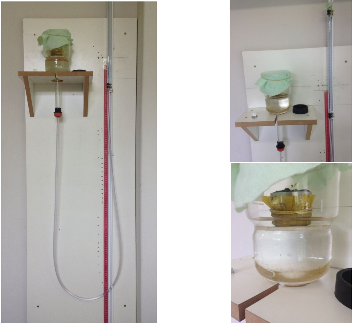
FIGURA 11 - EQUIPAMENTO UTILIZADO PARA A OBTENÇÃO DA CURVA DE RETENÇÃO DE ÁGUA (FUNIL DE HAINES).
