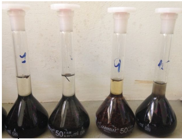
FIGURA 8 - BALÕES VOLUMÉTRICOS DE 50 mL PREENCHIDOS POR SUBSTRATO E ÁLCOOL
