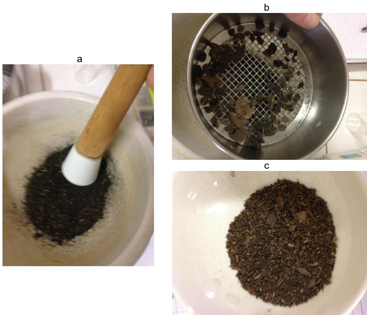
FIGURA 7 - ETAPAS PARA PREPARO DE SUBSTRATO PARA DENSIDADE DE PARTÍCULAS E ANÁLISE TEXTURAL. a) moagem do substrato retirado da estufa. b) passagem por peneira de 4,0 mm. c) substrato pronto para as análises vigentes.
