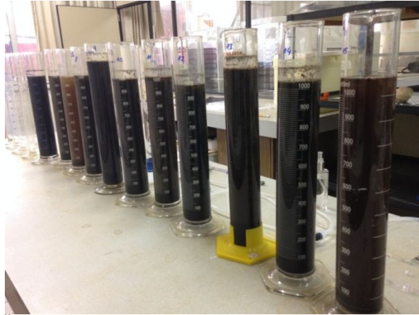
FIGURA 9 - SUSPENSÃO AQUOSA DOS SUBSTRATOS EM PROVETAS DE 1000 mL PARA ANÁLISE TEXTURAL PELO MÉTODO DO DENSÍMETRO
