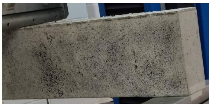
Figura 25 - Padrão de pontos aleatórios com tinta preta
