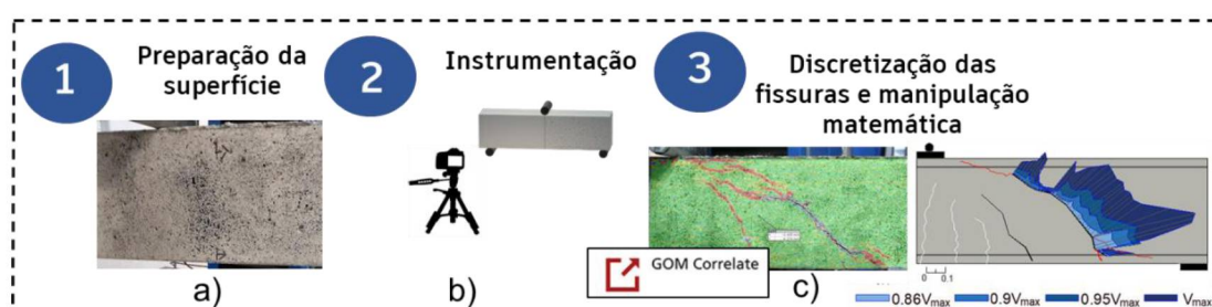
Figura 26 - Metodologia DIC. a) preparação da superfície, b) instrumentação e c) discretização das vigas
