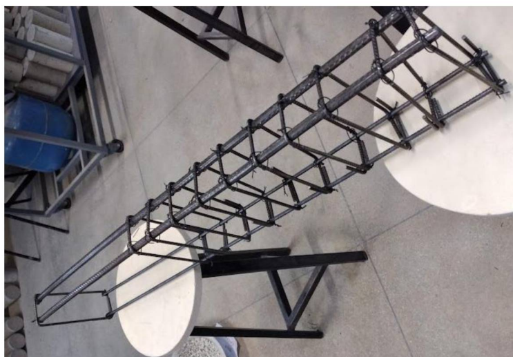
Figura 15 - Armadura das vigas esbeltas
