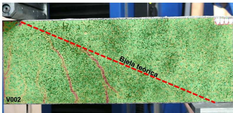
Figura 36 - Biela teórica da viga V002
