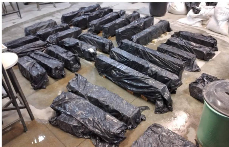
Figura 17 - Corpos de prova envoltos em lona após concretagem
