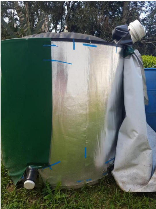
IMAGEM 5 - BIODIGESTOR PROTÓTIPO DA CWBIOGAS SEM CAPA.
