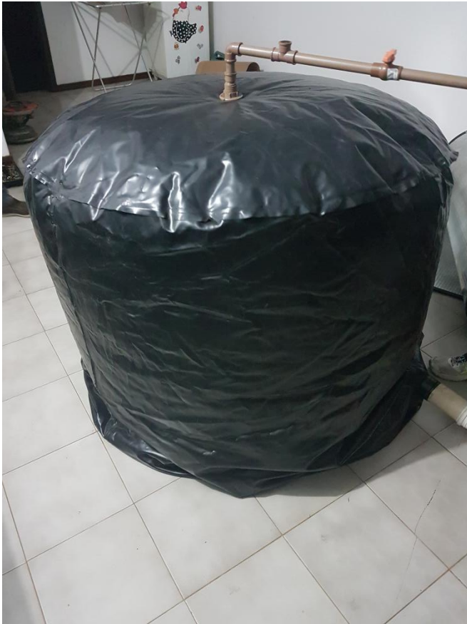
IMAGEM 8 - BIODIGESTOR INFLADO PARA TESTE DE QUALIDADE.
