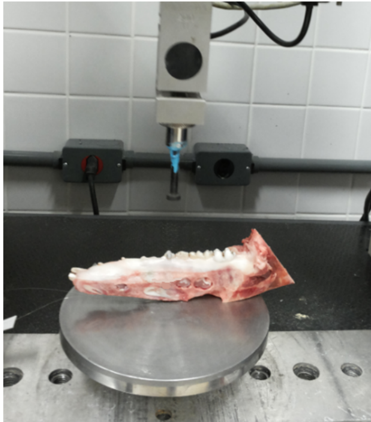
Figura 35- ESQUEMA DE MONTAGEM PARA O ENSAIO DE COMPRESSÃO.
