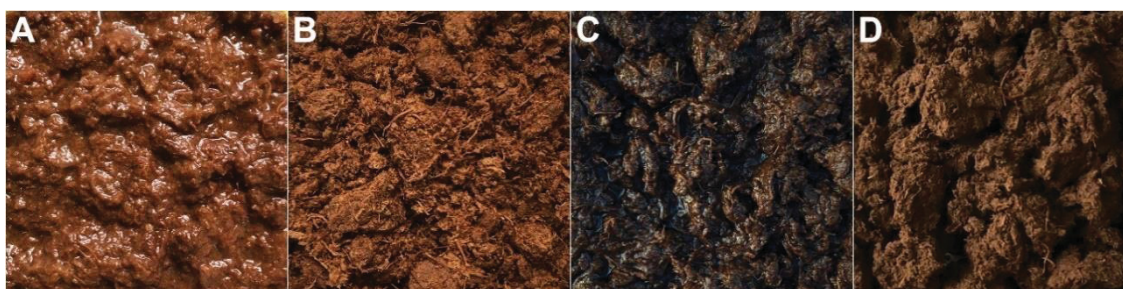
Figura 9. Aspecto das amostras explodidas a vapor a 195 °C por 7.5 (A e B) e 15 min (C e D)
