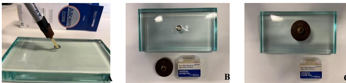
Figura 1. A. Inserindo o cimento resinoso no centro da matriz. B. Colocação da tira de poliéster sobre o conjunto matriz- cimento. C. Colocação do peso sobre o conjunto.
