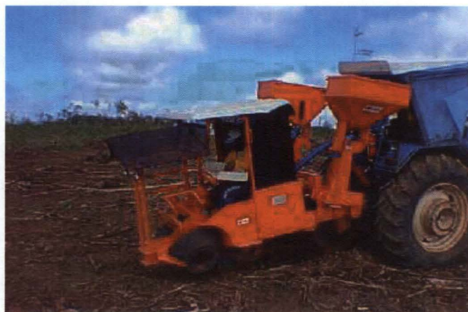
Figura 6 - Transplantadora de acionamento mecânico com adubadeira acoplada.
