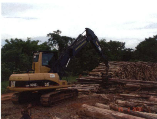
Traçador mecânico na operação seccionamento da madeira
