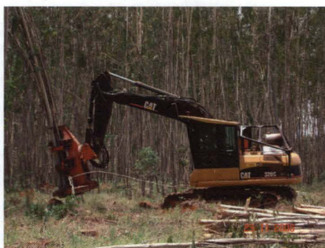
Feller Buncher na operação de derrubada
