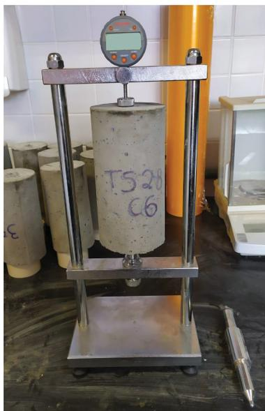
Antes de cada leitura e demais ensaios ( $18 \pm 2$ h antes), os recipientes contendo os corpos de prova eram removidos do ambiente com temperatura controlada para estabilização da temperatura com o ambiente. Após a leitura, todos os corpos de prova de expansão eram recolocados nos recipientes, invertendo a posição em relação ao armazenamento anterior, seguindo novamente para as condições de ensaio. Nesse mesmo período foi realizada a pesagem e avaliação visual das amostras.
