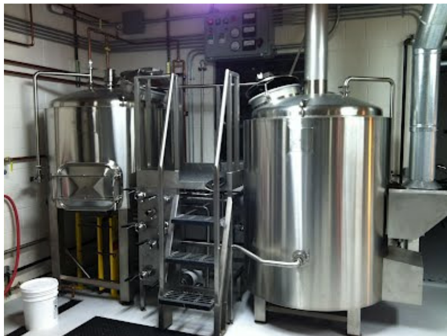
Figura 6.3: Sala de cozimento de sistema de 7BBL de capacidade. Fonte: (HARVESTER BREWING, 2013).
