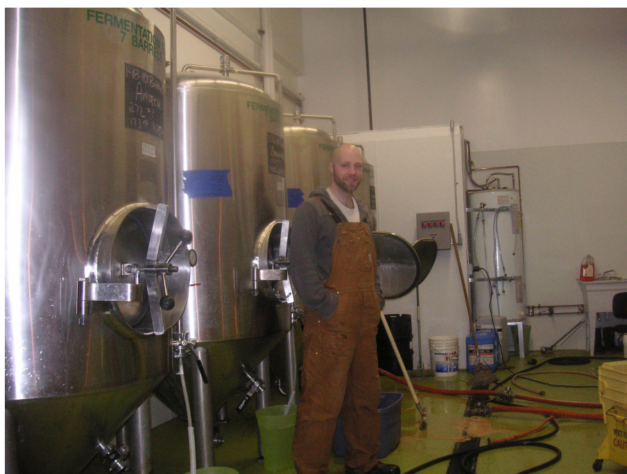
Figura 6.4: Tanques de fermentação 7BBL com escala humana. Em segundo plano, tanque de glicol 5 . Fonte: (GROVE STREET BREWHOUSE, 2013).
