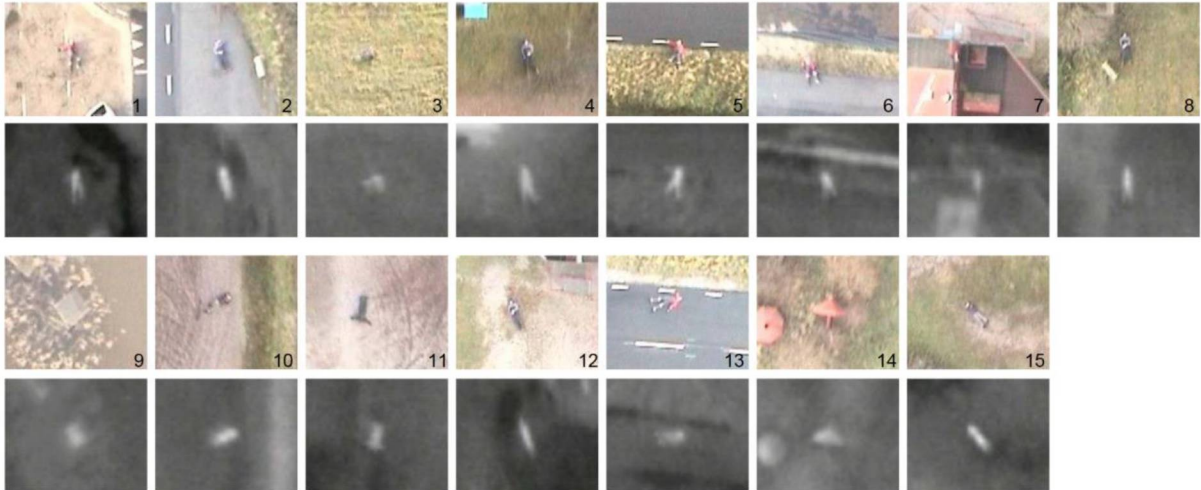
Figura 5: Imagens dos corpos classificados e suas respectivas imagens térmicas. Fonte: (Rudol & Doherty, 2008.)
