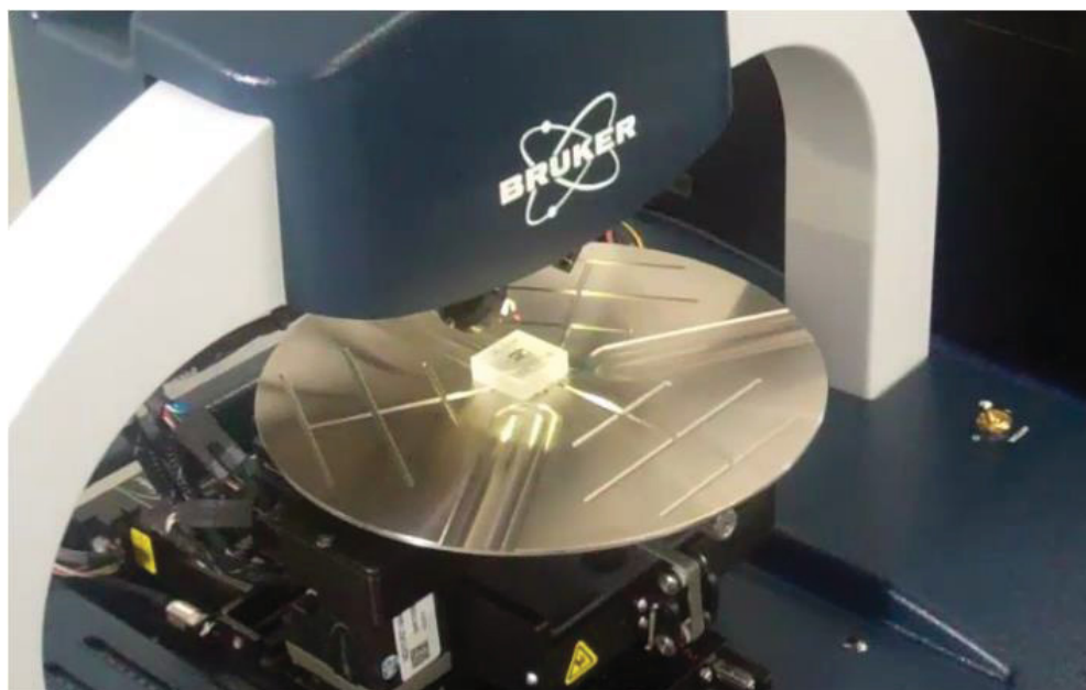
Figura 19: Foto da parte interna do perfilômetro com uma amostra sendo analisada. Imagem extraída da referência [97].
