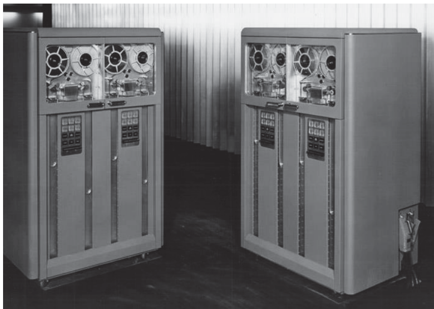
Figura 2: Foto do IBM 726. Primeiro sistema de armazenamento de alta velocidade com fitas magnéticas [9].
