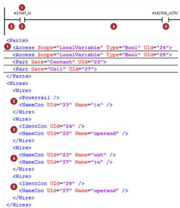
Figura 54 - Exemplo geral da relação entre Parts e Wires .
