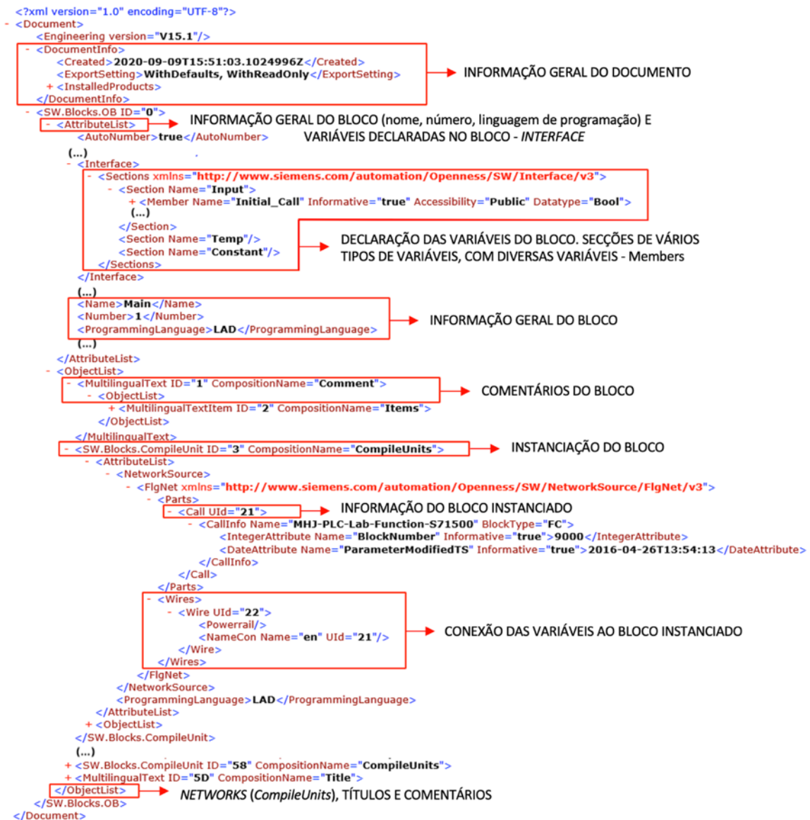
Figura 55 - Estrutura do XML de um organization block .
