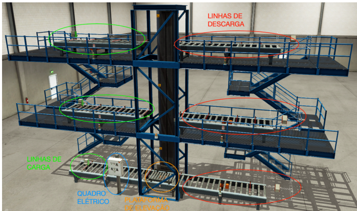
Figura 34 - Layout desenvolvido no Factory IO
