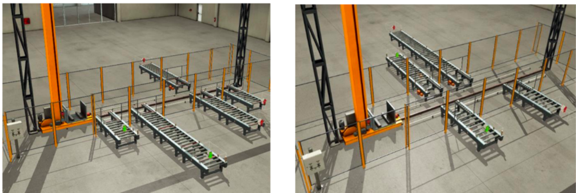
Figura 28 - Layouts exemplares distintos no ambiente de simulação. In Henrique Domingos, Desenvolvimento de uma aplicação para geração automática de código para o PLC de controlo de um shuttle car , 2018.
