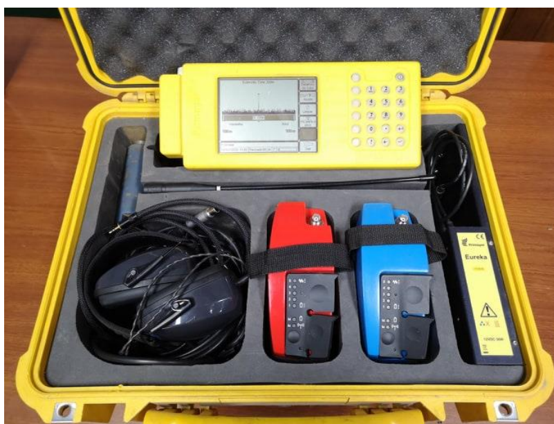
Figura 7: Correlador de ruído de fugas das Águas de Gaia, EM, S.A.
