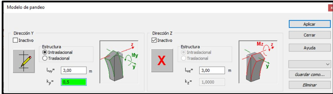
Figura 64. Configuración de pandeo en eje "Y" y "Z"
