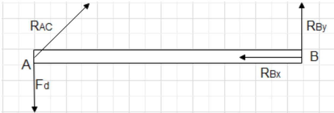
Figura 31. Segmento  $\overline{AB}$ , diagrama de cuerpo libre (DCL)
