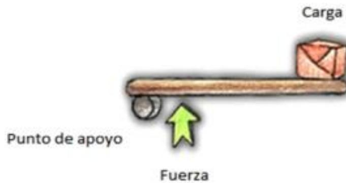
Figura 18. Palanca de Tercer grado [25]
