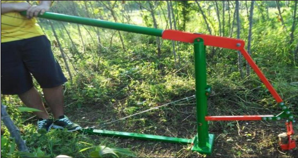
Figura 21. Prototipo de Máquina extractora mecanizada para mandioca [23]
