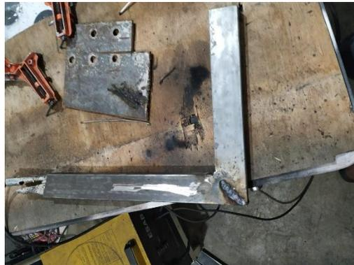
Figura 65. Proceso de suelda SMAW del perfil metálico
