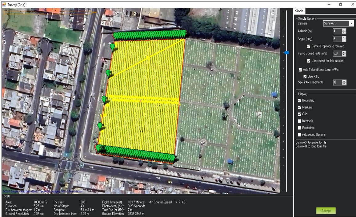
Figura 54 Configuración de los parámetros del terreno.
