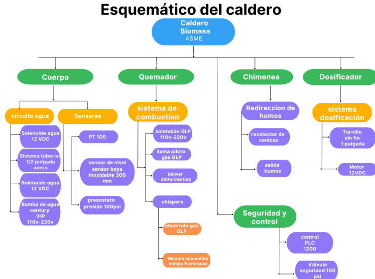
Figura 10. Esquema caldero.
