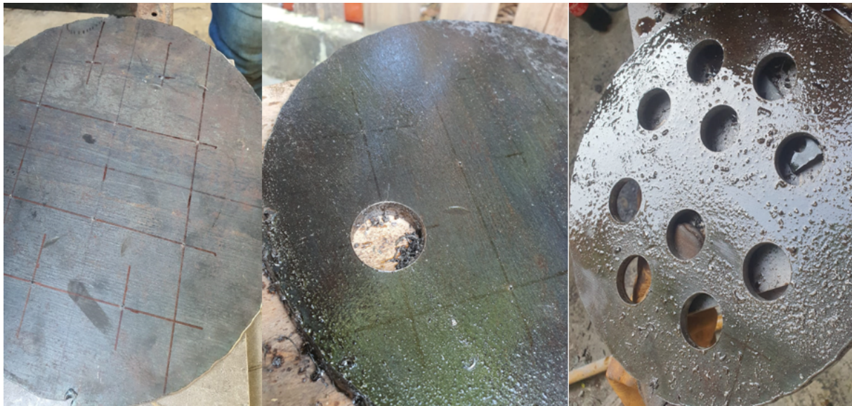
Figura 76. Perforación de espejos.
