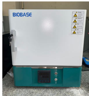
Figura 23. Mufla utilizada para obtención de muestras.
