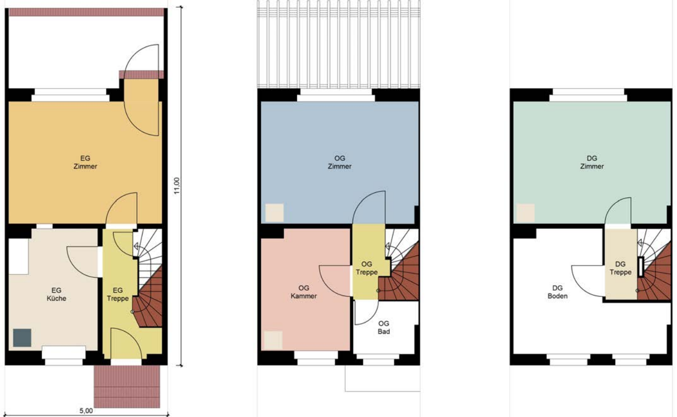
Darstellung der restauratorischen Befunduntersuchungen in einem Reihenhaus von Hugo Häring im Bereich 1. Die Wandfarben sind flächig und die Deckenfarbe als separates Kästchen im jeweiligen Raum dargestellt.
