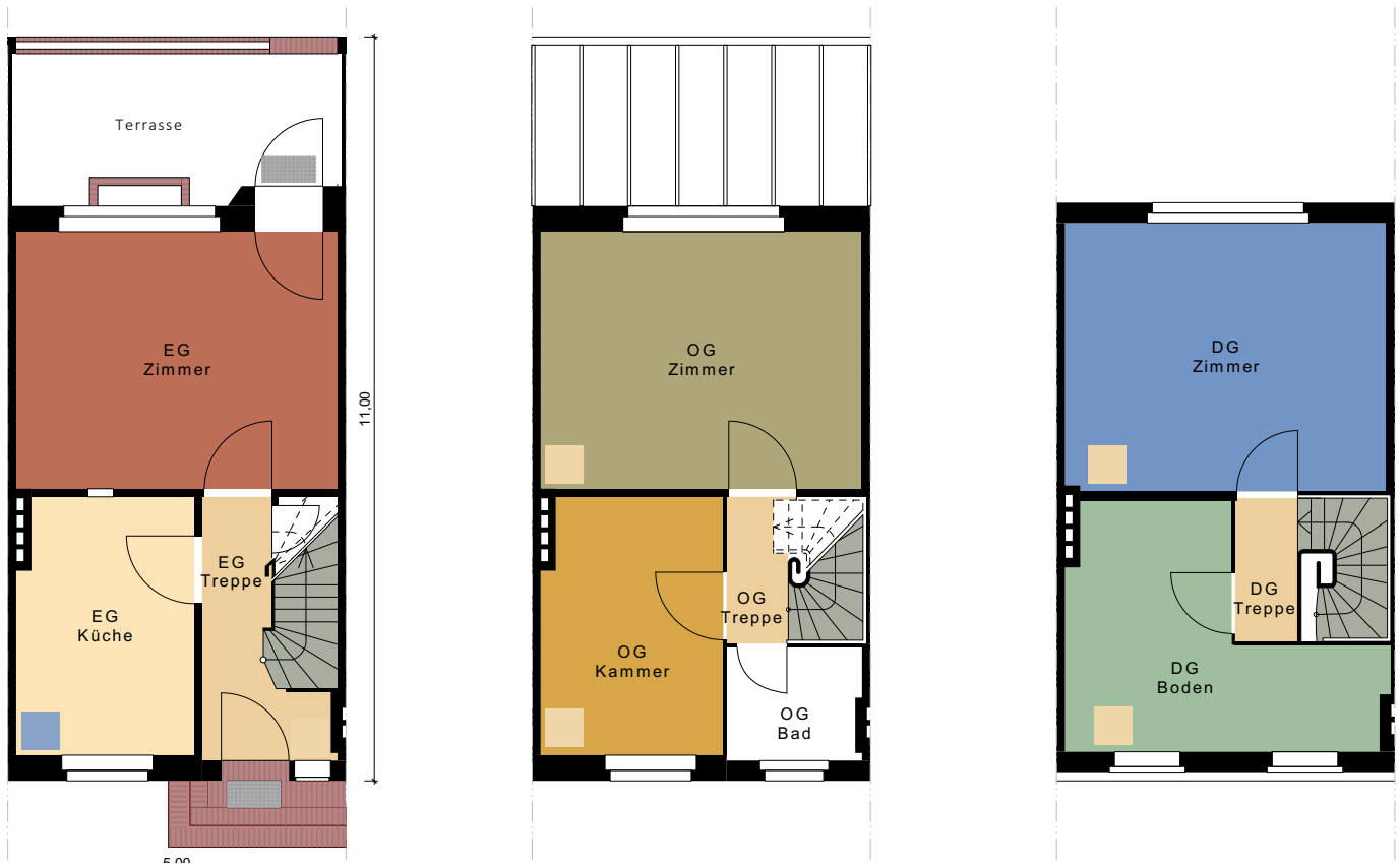
Darstellung der restauratorischen Befunduntersuchungen in einem Reihenhaus von Bruno Taut im Bereich 4. Die Wandfarben sind flächig und die Deckenfarbe als separates Kästchen im jeweiligen Raum dargestellt.
