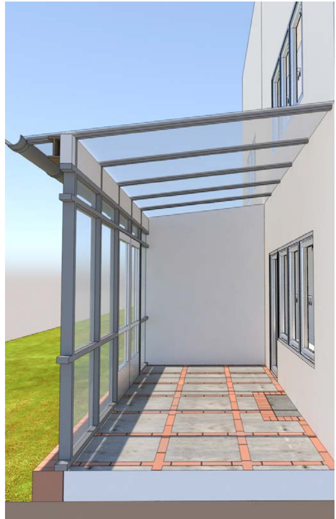
Anbau als Wintergarten unter Erhalt der bauzeitlichen Fassade und des Terrassenbodens.
