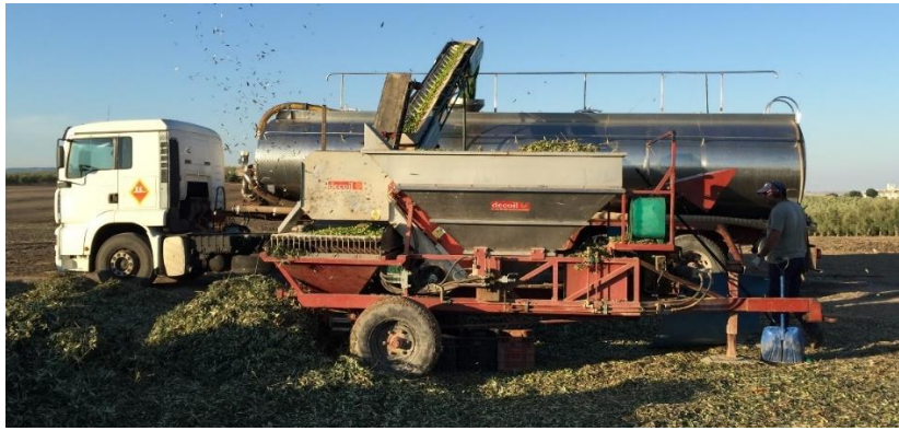
Figura 5. Limpieza de la aceituna de mesa e inmersión en líquido para transporte a industria
