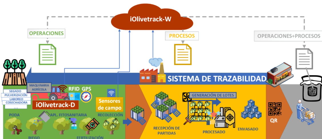
Figura 38. Metodología y sistemas desarrollados para la gestión integral de la trazabilidad desde el campo hasta la industria
