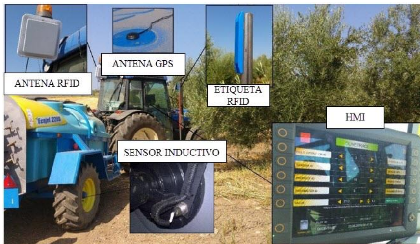
Figura 48. Prueba realizada con iOlivetrack-D a bordo de la maquinaria para cargar los datos de campo en iOlivetrack-W. Ejemplo de identificación de sectores mediante la opción RFID
