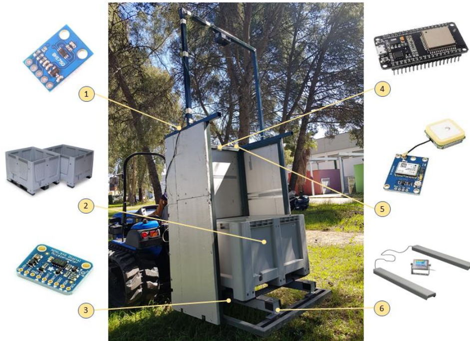
Figura 23. Estructura del sistema comercial montado en el tractor para la instalación de los sistemas de medida y elementos auxiliares. 1.-Luxómetro, 2.-Big box, 3.-Acelerómetro, 4.-Microcontrolador, 5.- GNSS, 6.-Célula de carga.
