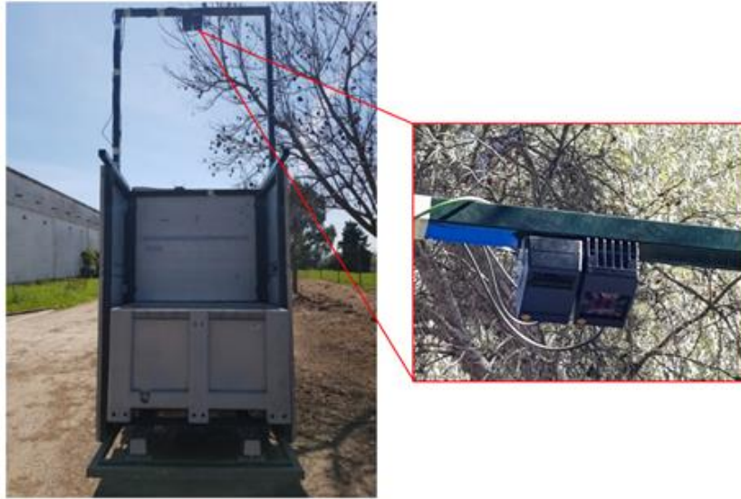
Figura 24. Prototipo de monitor de rendimiento desarrollado con el sistema comercial sobre una estructura metálica y big box para almacenar el fruto (izquierda). Detalle de la cámara 3D (derecha).
