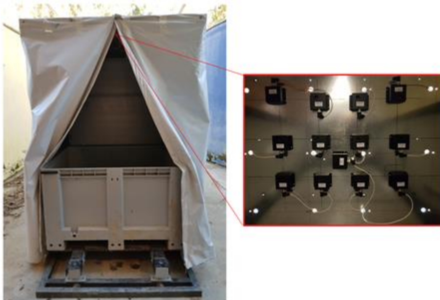
Figura 25. Prototipo de monitor de rendimiento desarrollado con el sistema experimental sobre una estructura metálica y un big box para almacenar el fruto (izquierda). Detalle del conjunto de sensores ToF (derecha).
