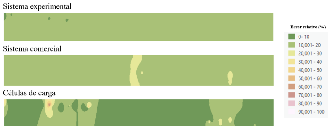
Figura 37. Variación del error relativo del peso teniendo en cuenta la carga transportada durante la prueba dinámica para diferentes sistemas
