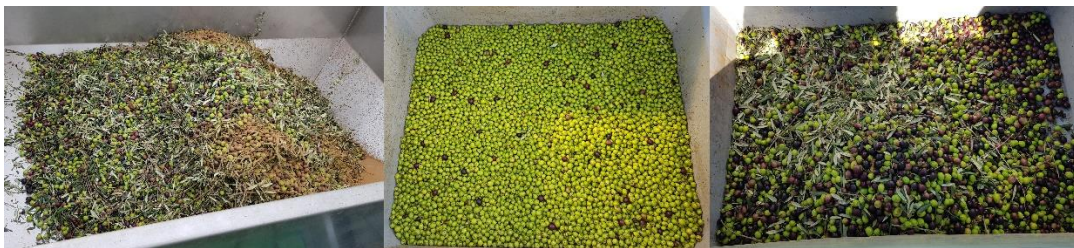
Figura 66. Entrada de fruto en la tolva (izquierda) y salida de calidad 'A' (centro) y 'B' (derecha)
