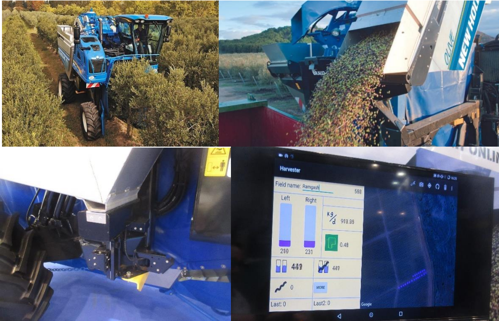
Figura 8. Cosechadora cabalgante para olivar superintensivo. Detalle de descarga de tolvas de almacenamiento del fruto en remolque (arriba). Sistema de monitorización de rendimiento (abajo) (New Holland, 2023).
