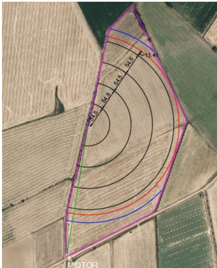
Ilustración 1: Mapa detalle del diseño del pivot en la parcela y la ubicación del motor.
