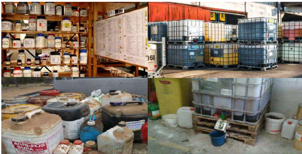
Figura 22. Ejemplos de almacenamiento inadecuado de residuos peligrosos. Fuente: (Durand, 2017).
