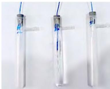
Figura 3.12. Llenado y sellado de las muestras de PCM y agua (sustancia de referencia) del T-History.
