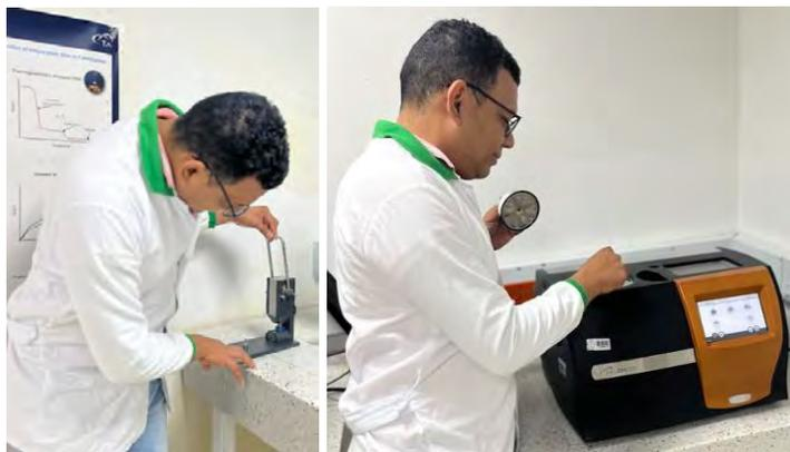
Figura A2.1. a) Proceso de sellado de las muestras. b) Montaje de la muestra en el equipo DSC
