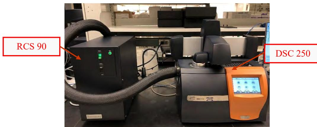
Figura 3.1. Equipo experimental para las calorimetrías
