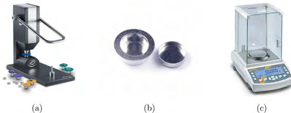
Figura 3.2. Dispositivos utilizados para la preparación de la muestra. (a) Prensa, (b) crisol y tapa (c) balanza analítica.
