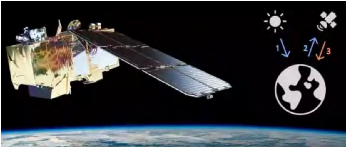
Figura 2-2. Esquema básico de teledetección pasiva. Fuente: Earth Observing System (EOS Data Analytics, 2021)
