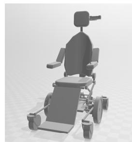
Figura 1 Prototipo virtual de la plataforma de movilidad
