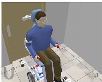
Figura 5 Escena en la simulación del caso de estudio donde un usuario está sentado en la plataforma de movilidad, que incorpora la pulsera en el brazo derecho, las gafas, la cámara y su soporte.
