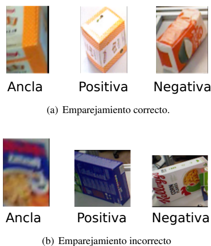
Figura 7: Ejemplos de emparejamiento correcto e incorrecto utilizando la red triplete S-RESNET50-SPP-FC. La imagen ancla es capturada con las gafas de seguimiento ocular, mientras que las imágenes positiva y negativa son capturadas con la cámara del robot. En el emparejamiento correcto, la red identifica la imagen positiva como la más similar a la ancla. Por otro lado, en el emparejamiento incorrecto, la red incorrectamente asocia la imagen negativa como la más similar.
