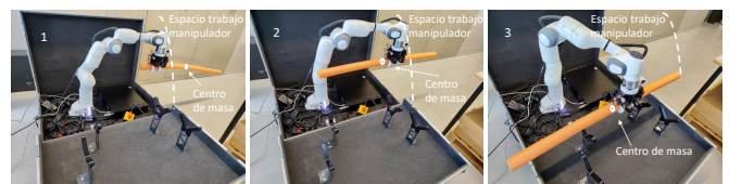
(a) Ampliación de espacio de trabajo ( Pick, Roll and Place )
