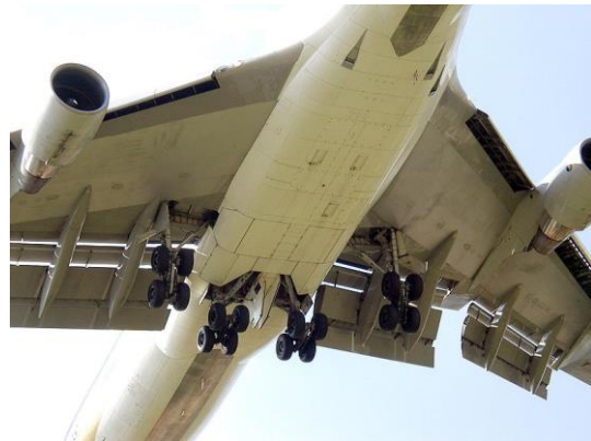
Figura 1: Flaps de borde de salida del ala y de borde de ataque y Slats en borde de ataque del ala desplegados para aterrizaje en Boeing B747.
