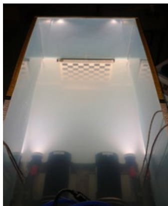
Figura 1: Tanque de pruebas con sistema estéreo e iluminación para caracterización de la turbidez.
