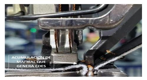
La erradicación de la tarea de acomodo de cubierta por parte del operador en las máquinas de costura se llevó a cabo mediante la modificación de las dimensiones del guiador de la máquina de costura el cual era el único herramental que hacía contacto con la cubierta a lo largo de todo el proceso de costura, se determinó que el problema nacía en el poco contacto que se tenía en guiador de costura con la cubierta y se aumentó el diámetro del guiador de pping original de (3,36 mm x 4,69 mm).
