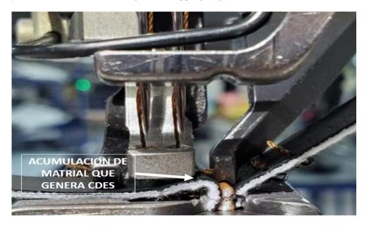
EL guiador de pping modificado que se implementó tiene las dimensiones de (6,96 mm x 3,58 mm), hay un mejor agarre de la cubierta sin necesidad de que el operador estire los dos extremos Automatizando así la tarea, el impacto fue positivo en la reducción de la variación del movimiento de la cubierta durante el procesamiento, evitando así la costura desalineada y malas costuras.
