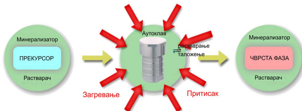
Слика 2.7. Шематски приказ хидротермалне/солвотермалне синтезе [71] са најчешће коришћеним аутоклавом.
