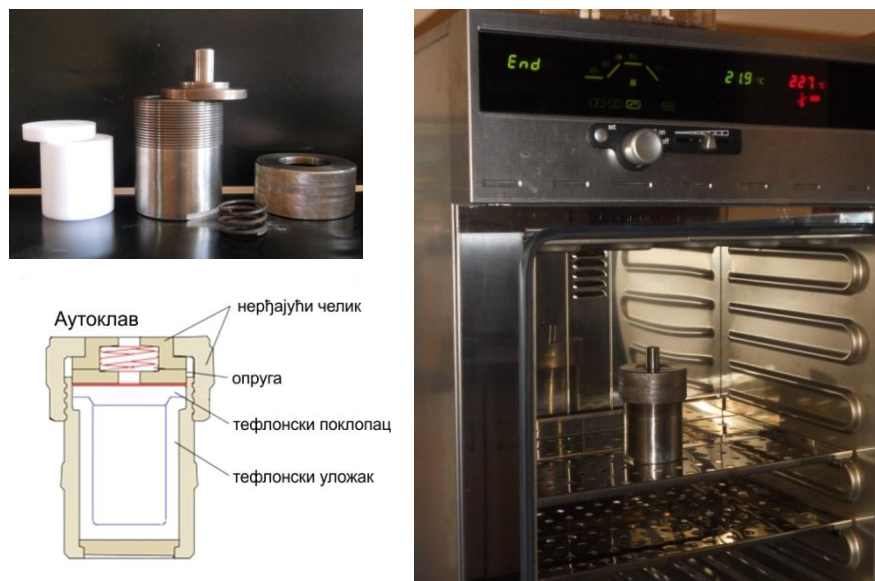
Слика 3.1. Хидротермални аутоклав са шематским приказом [70] и сушница коришћени у експерименталном раду.
