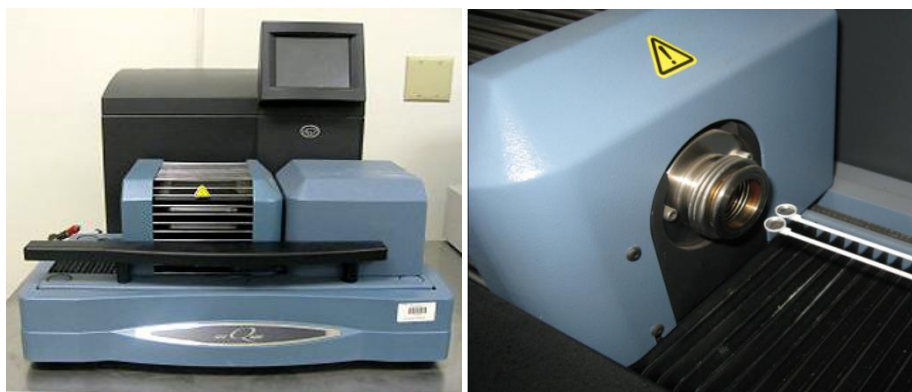
Слика 3.5. Уређај коришћен за TGA/DTA анализу – SDT Q600 V7.0 Build 84 .
