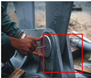
الشكل (29) طريقة تثبيت هيكل المركز
