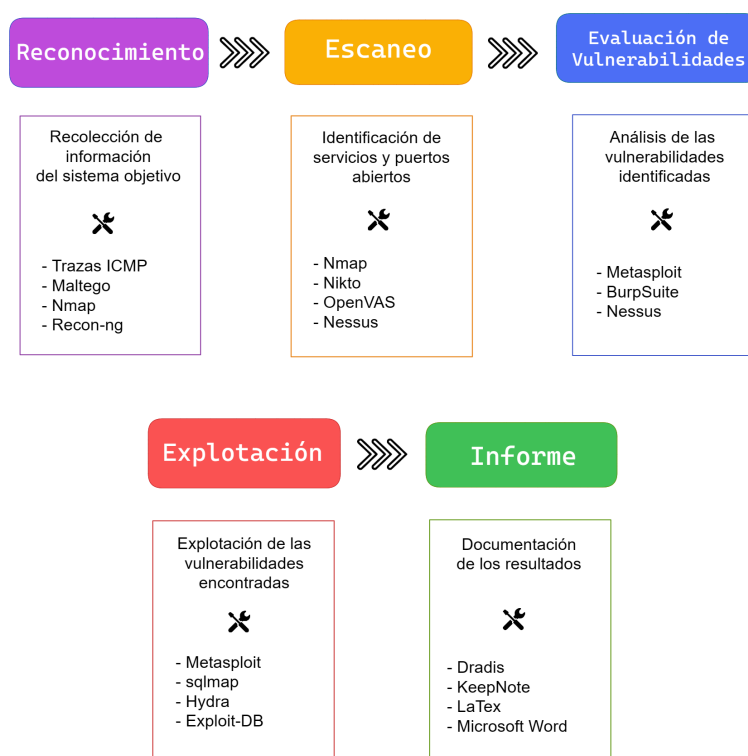
Figura 1.3: Descripción de las fases en el proceso de pentesting
