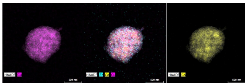
Figura 2: Imágenes de TEM del catalizador ZrHMS-7.5Cu-7.5Co.
