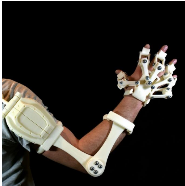
Imagen 4. Exoesqueleto impreso en 3D de la extremidad superior. [5]
